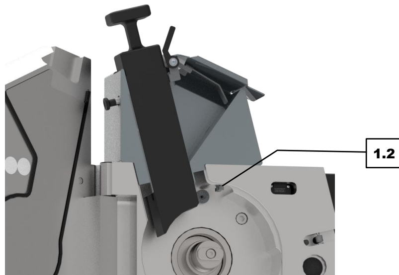
III. 13 : Monter la trémie dans le boîtier
