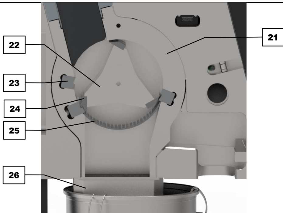
图 5：带重力出料口的重力插件的细节视图
