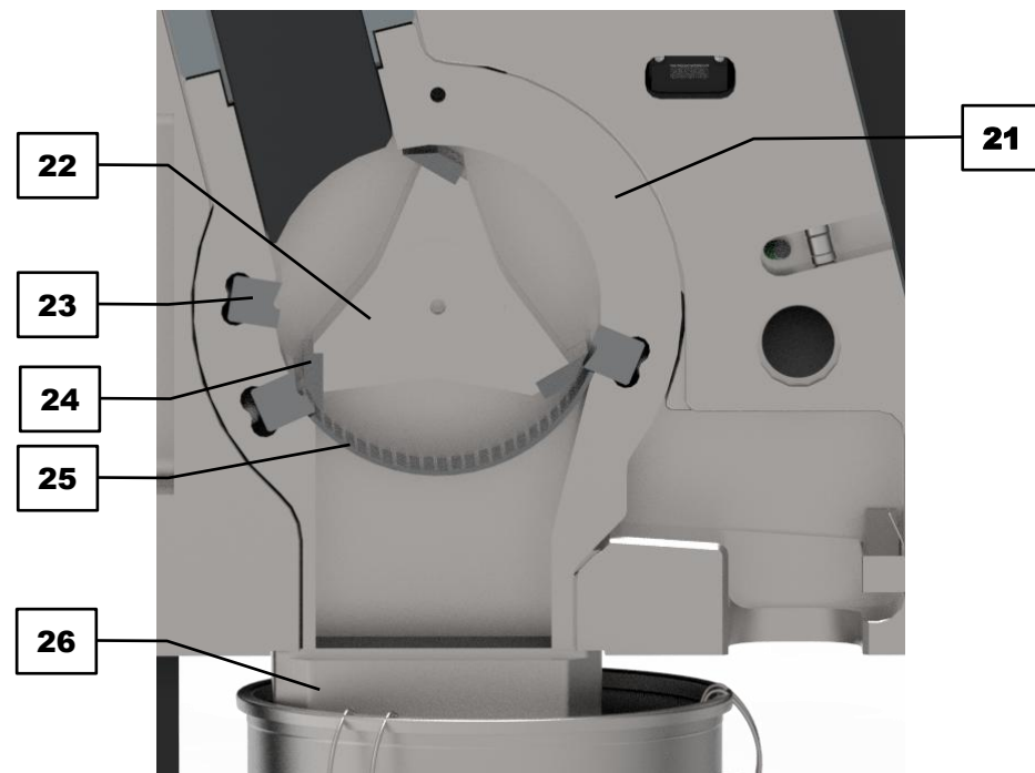
Fig. 5: Vista dettagliata dell'inserto a gravità con uscita a gravità
