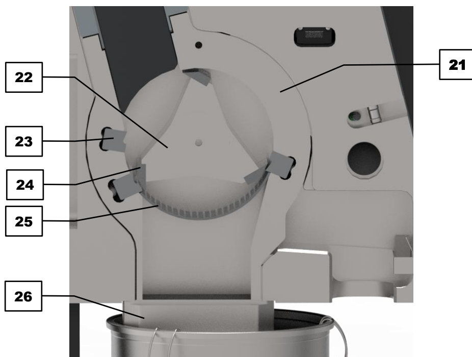
Fig. 5: Detalle de la pieza molturadora de caída libre con salida de caída libre
