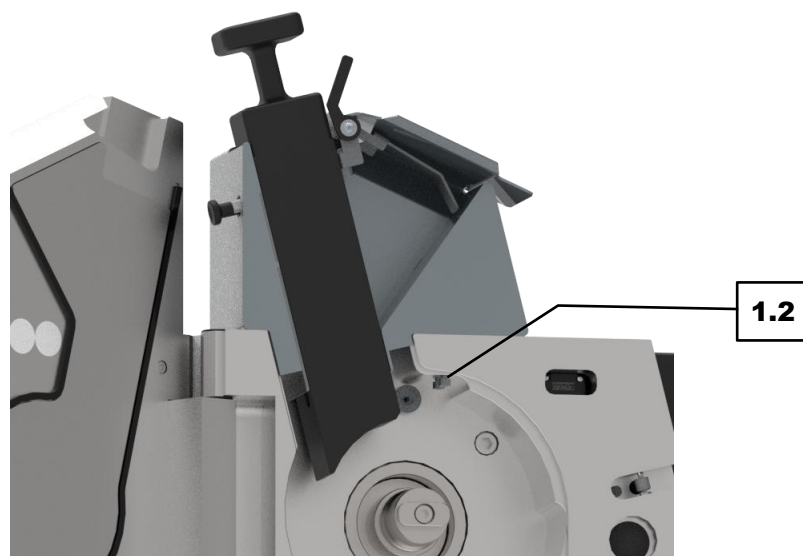
Fig. 14: Atornillar firmemente la tolva
