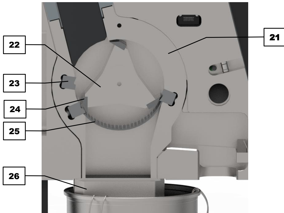
Abb. 5: Detailsicht Schwerkrafteinheit mit Schwerkraftauslass
