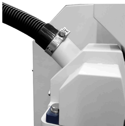
Przyłącze do odciągu pyłu
