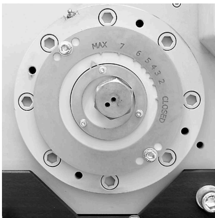
Skala do płynnego ustawienia szerokości szczeliny
