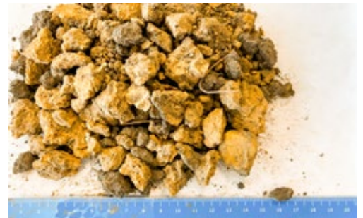
Boden-/ Steinagglomerate vorzerkleinert im Backenbrecher BB 50
