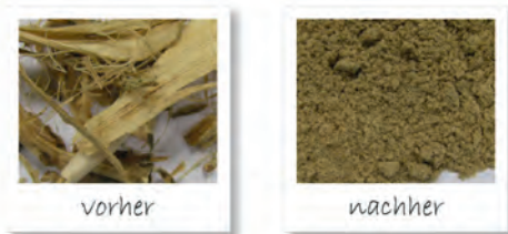
Bild 4: Maisstroh vor und nach der Zerkleinerung in der Schneidmühle.
