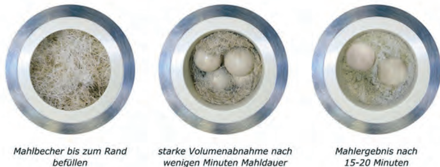
Bild 5: Das Befüllen der Mahlbecher einer Kugelmühle mit pflanzlichem Material erfolgt aufgrund der starken Volumenabnahme durch den Zerkleinerungsprozess bis zum Rand.
