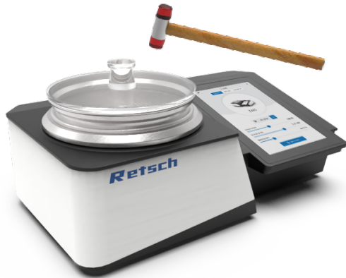
Fig. 11: Picchiettare con il martello morbido.
