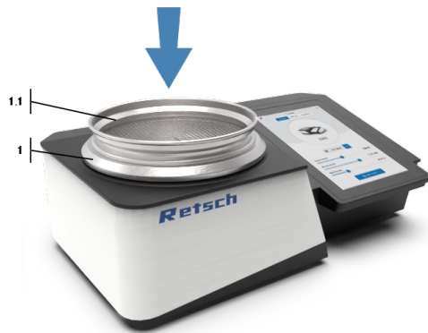
Abb. 8: Placer le tamis d'analyse 203 et 200 mm
