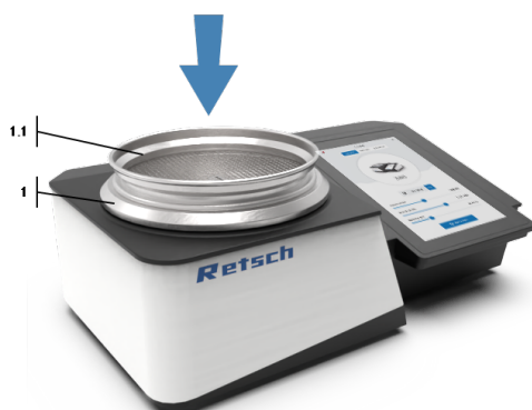
рис. 8: Установить аналитическое сито 203 и 200 мм
