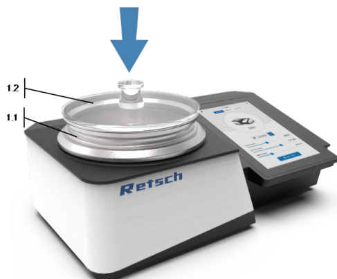
рис. 9: Установить крышку сита
