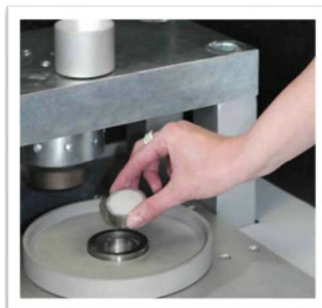
Рис. 3: Пеллеты, изготовленные с помощью пресса PP 40, отличаются высокой прочностью и имеют идеально гладкую поверхность
