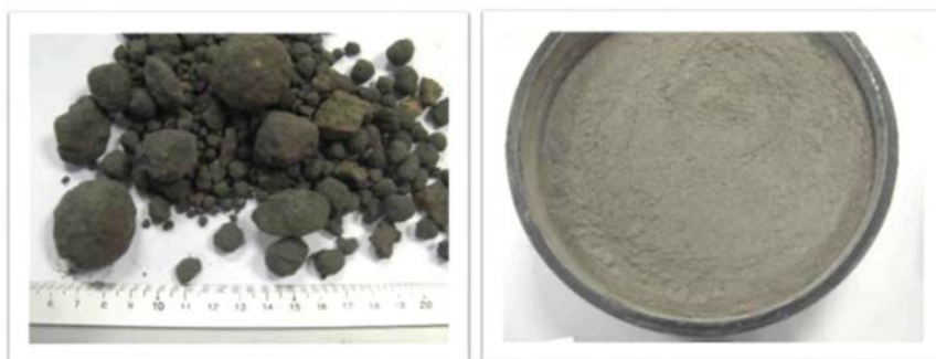
Рис. 2: Образец цементного клинкера до (слева) и после (справа) измельчения в мельнице RS 300 XL.
