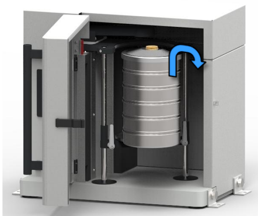
Рис. 8: Снятие колонны сита
