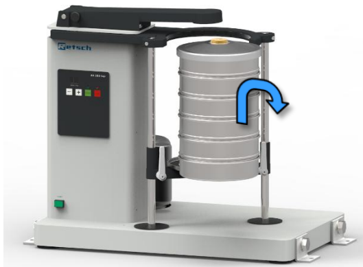
Рис. 10: Снятие колонны сита
