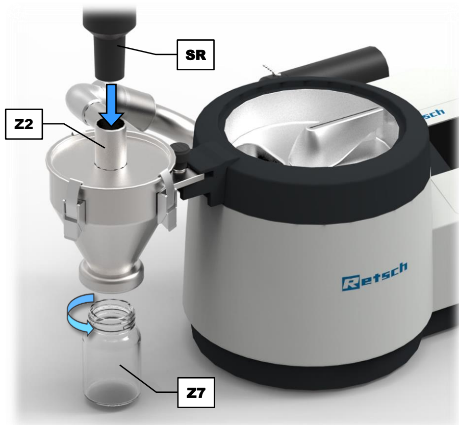
图30: 将工业吸尘器连接到安装的旋流分离器上
