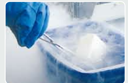
液体窒素に試料を封入したステンレス製ジャーを ひたします。
