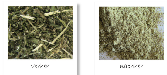
Abb. 4: Vorzerkleinerte Hanfprobe (li), nach Pulverisierung in der ZM 300 (re.)
