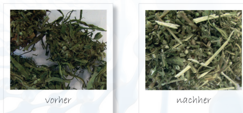
Abb. 2: Hanfprobe vor (li.) und nach (re.) der Zerkleinerung in der SM 400 XL
