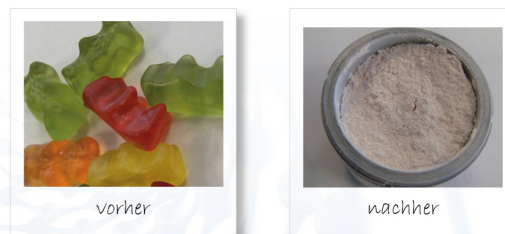
Abb. 8: Gummibärchen vor (li.) und nach der Kryogenvermahlung in der CryoMill (re.)
