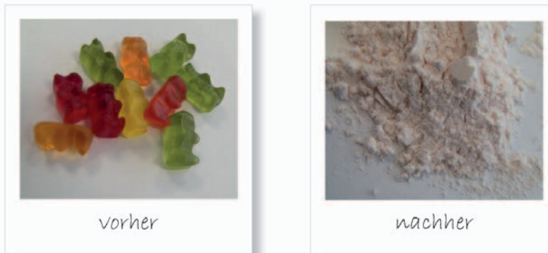
Bild 3: Gummibärchen vor und nach der Homogenisierung mit Trockenis in der Grindomix GM 300. (Bild: Retsch)
