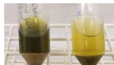
Fig. 7: Il campione di canapa macinato nel CryoMill (a sinistra) produce una quantità di pesticidi maggiore dopo l'estrazione rispetto al campione macinato nello ZM 300 (a destra).
