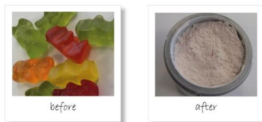
Fig. 8: Orsetti di gelatina prima (sinistra) e dopo la macinazione criogenica nel Vibromulino MM400
