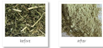
Fig. 4: Dopo il pre-taglio nell'SM 400 XL (a sinistra) il campione viene polverizzato a <0,5 mm nello ZM 300
