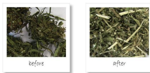
Fig.2: Campione iniziale di canapa (sinistra) e finale, dopo la riduzione con SM 400 XL (destra)
