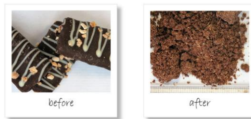
Fig. 10: Biscotti prima (sinistra) e dopo la polverizzazione nel mulino a coltelli GM 200 (destra)
