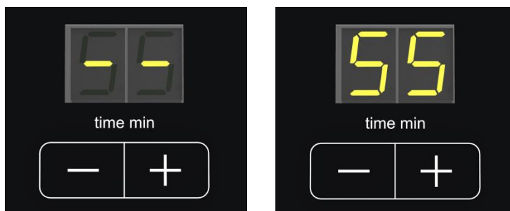
III. 13: Réglage de temps en service permanent (à gauche) ou avec une durée de processus (à droite)
