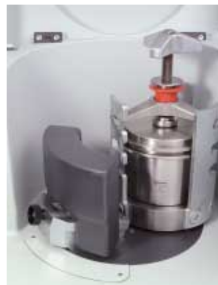
Fig. 4: Para un equilibrio óptimo, en el PM 100, se puede colocar el contrapeso en un raíl guía oblicua
