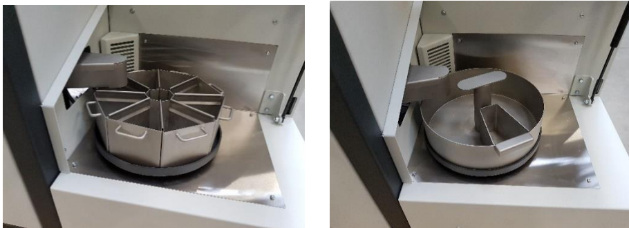
Abb. 19: Eingesetztes Teilmodul für 8 Teilproben bzw. eine Teilprobe mit Verwurf
