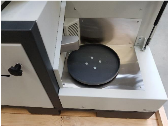
Fig. 18: Vista del piatto rotante senza modulo di ripartizione
