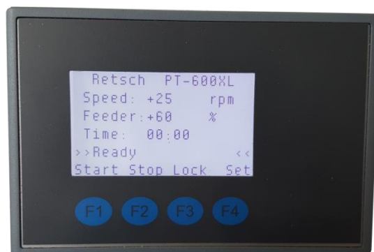
Fig. 23: Bloccato e pronto per l'avvio
