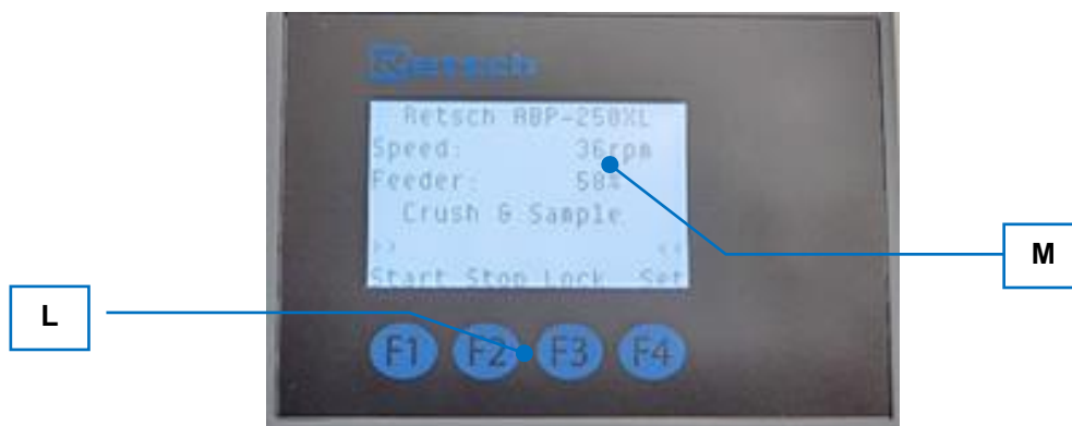
Fig. 7: Display con tasti funzione
