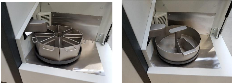
Fig. 19: Modulo di ripartizione inserito per 8 ripartizioni campione risp. per una ripartizione campione con scarico
