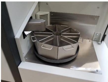
III. 19 : Module partiel en place pour 8 échantillons partiels ou avec un échantillon partiel avec rejet
