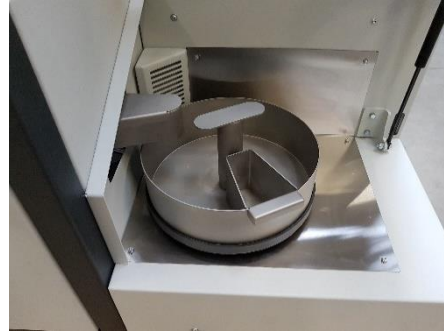
III. 19 : Module partiel en place pour 8 échantillons partiels ou avec un échantillon partiel avec rejet
