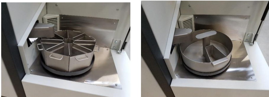
Fig. 19: Módulo divisor insertado para 8 submuestras o bien una submuestra con parte sobrante
