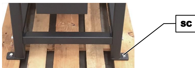
Рис. 3: Крепление на транспортировочном поддоне
