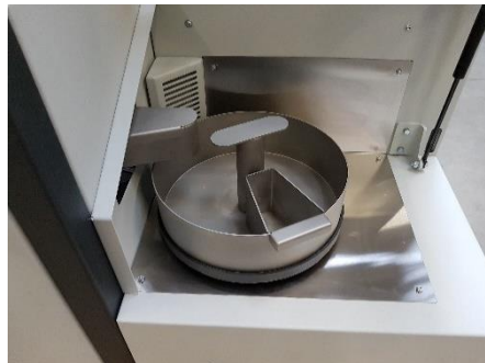
図 19： 8分割用モジュールまたは1分割試料排出機構付きモジュールが挿入された回転ディスク
