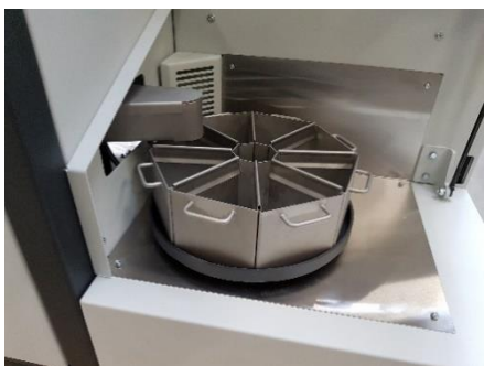
図 19： 8分割用モジュールまたは1分割試料排出機構付きモジュールが挿入された回転ディスク
