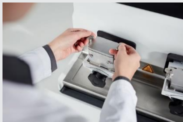
Fig. 2: Le innovative giare con pratico serraggio a vite permettono il fissaggio in pochi secondi
