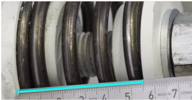
Fig. 11: Tensión previa del resorte
