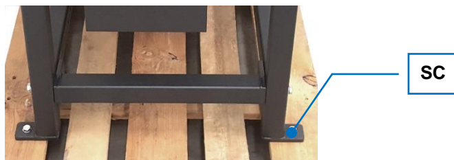
Рис. 9: Крепление на транспортировочном поддоне
