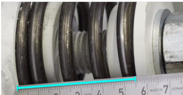
III. 11 : Pré-tension de ressort
