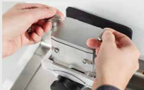
図3：上蓋スクリーロック式粉砕ジャーは取り扱いが簡単で、すばやく開閉できます。上部が開放するジャーは、本体に固定したまま試料を取り出せるため、効率の良いサンプリングが可能です。
