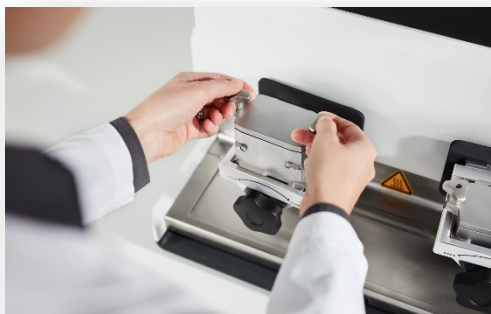
Fig. 2: Los nuevos recipientes de molienda Screw-Lock son muy fáciles de manejar: sólo se necesitan unos segundos para introducirlos en el molino.
