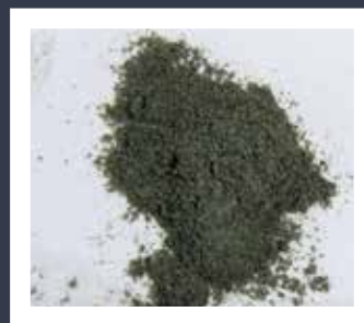
ТОНКОЕ ИЗМЕЛЬЧЕНИЕ В КРИОГЕННОЙ МЕЛЬНИЦЕ CRYOMILL ДО ДОСТИЖЕНИЯ КОНЕЧНОЙ ТОНКОСТИ 200 МКМ
