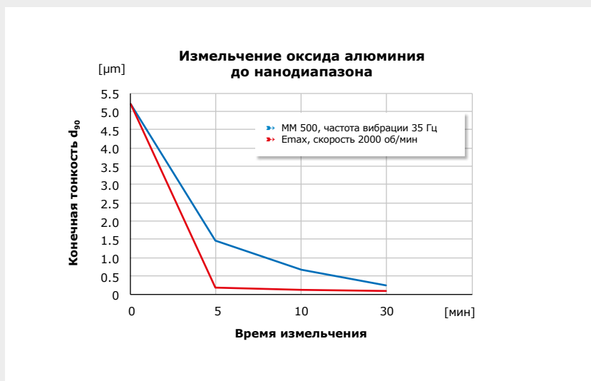
Рис. 3: Измельчение оксида алюминия в вибрационной мельнице MM 500 и мельнице Emax.
