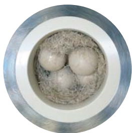
Reducción notable del volumen de la muestra después de pocos minutos de trituración.
