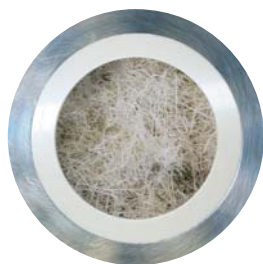
Le bol de broyage doit être rempli jusqu'au bord.
