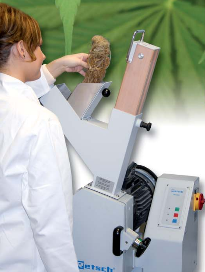
Fig. 1 : alimentation du SM 2000 avec des fibres de chanvre
