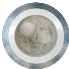
Résultat du broyage au bout de 15 à 20 minutes.
