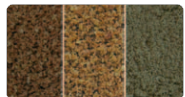
■ Resultado de la trituración: muestras con una finura < 1 mm
