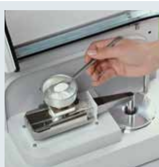
Abb. 4: Sollen pulverförmige Materialien im trockenen Zustand gemessen werden, so ist dies mit der optionalen Trockendispergierereinheit PowderJet möglich.
