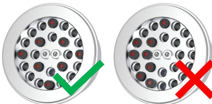
Fig. 34: Disposición admisible de los recipientes de vidrio en el adaptador
