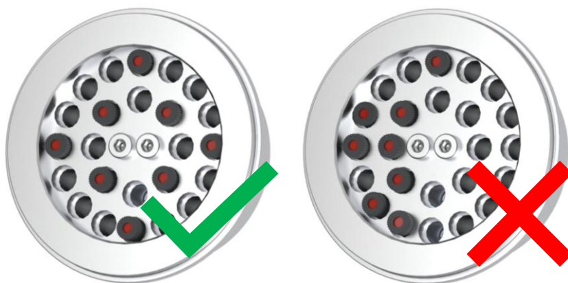
Fig. 34: Disposizione consentita dei contenitori di centro nell'adattatore
