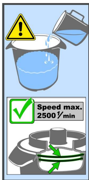
Fig. 4: Velocidad máxima en caso de muestras muy fluidas
