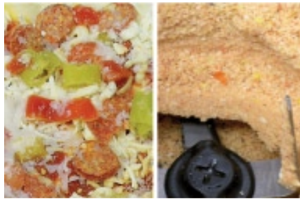
Abb. 2: In der GM 300 lässt sich eine komplette Tiefkühlpizza innerhalb von 30s homogenisieren.
