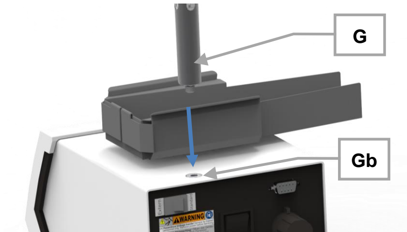
Fig. 13: Montar la barra para el soporte de la tolva
