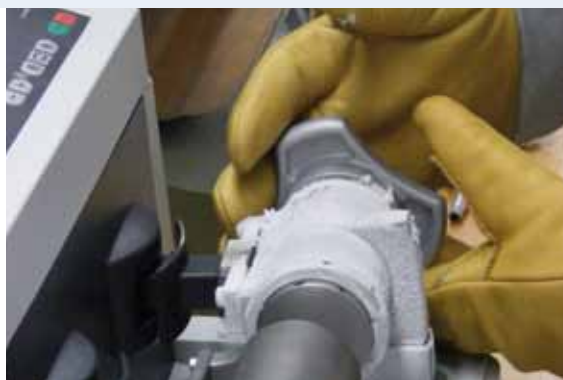
Für die Vermahlung von Meerrettich wird in Cottbus die CryoMill eingesetzt, um die typische Schärfe des Produkts zu bewahren.
