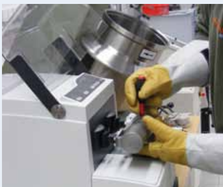
Für die Vermahlung von Meerrettich wird in Cottbus die CryoMill eingesetzt, um die typische Schärfe des Produkts zu bewahren.
